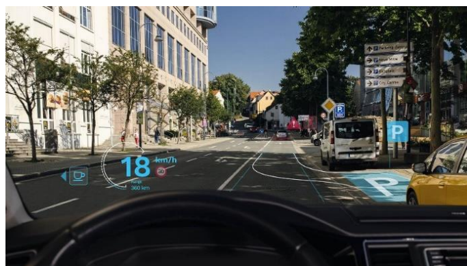
圖 4、Zeiss 全像攝影技術應用於擋風玻璃示意圖
